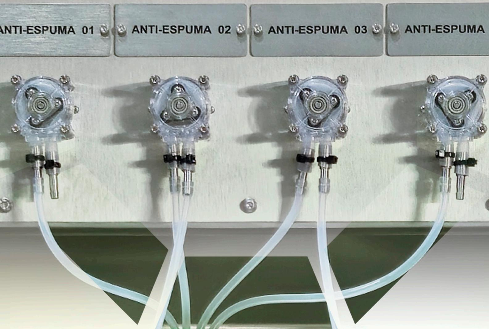
Dispositivo de transferência asséptica de reagentes especiais.
